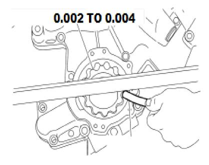
BEFORE INSTALLING THE OIL PUMP HOUSING & ROTOR SET ON THE ENGINE. USING A STRAIGHT EDGE AND A FEELER GAUGE, MEASURE THE HEIGHT CLEARANCE BETWEEN THE OIL PUMP HOUSING AND THE INNER AND OUTER ROTOR. THE INNER AND OUTER ROTOR. THE INNER AND OUTER ROTOR MUST BE 0.002 TO 0.004 BELOW THE OIL PUMP HOUSING.
